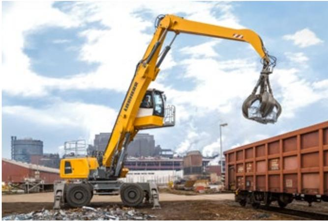
Chargement de paquets d'aluminium pressés dans des wagons avec la LH 50 M Industry Litronic
